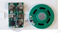
• RECORDABLE SOUND MODULE WITH A HINGE SWITCH, A MICROPHONE & A PLAY-BUTTON
